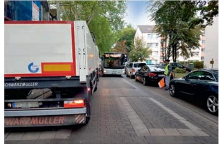
In dieser Parkposition wurden zudem die Stützen des Kran-LKW nicht korrekt ausgefahren. Somit besteht in diesem Fall die Gefahr, dass das Fahrzeug beim Schwenken des Krans mit den beladenen Paletten umstürzt. Auch das Absetzen der 1,7 Tonnen schweren Pakete birgt Risiken: Da die Traglast des Untergrundes nicht sichergestellt ist, könnte der Gehweg beschädigt werden.
