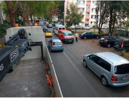
Zum Entladen des LKW wird in der Parkposition – bei ausgefahrenen Stützen – die Ladungssicherung entsprechend entfernt. Anschließend können die Leichtbetonprodukte dann mit dem Kran an die gewünschte Stelle gehoben werden. Um Sicherungsgurte oder anderes Befestigungsmaterial zu lösen, müssen allerdings die Seitenwände des Kranfahrzeugs geöffnet werden. Hierfür benötigen die
