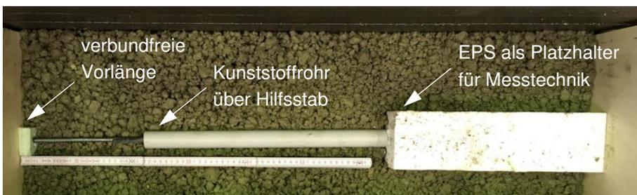
Abbildung 3-18: Bewehrungsstab mit Endhaken, angeschweißtem Hilfsstab, Kunststoffrohr und EPS-Platzhalter
