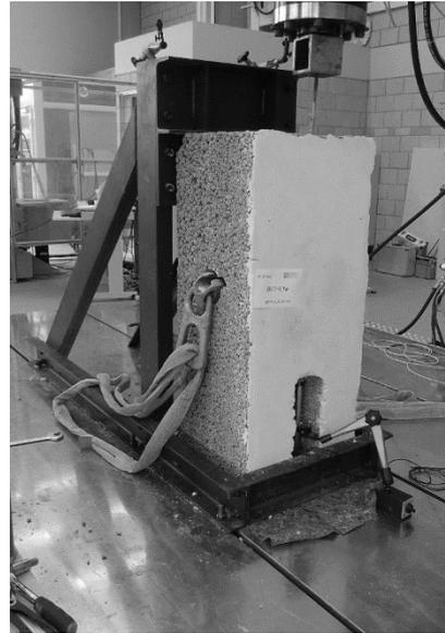
Abbildung 3-4: Stahlrahmen mit eingebautem Prüfkörper
