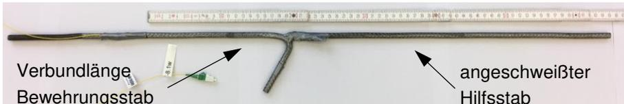
Abbildung 3-16: Bewehrungsstab mit Endhaken und angeschweißtem Hilfsstab
