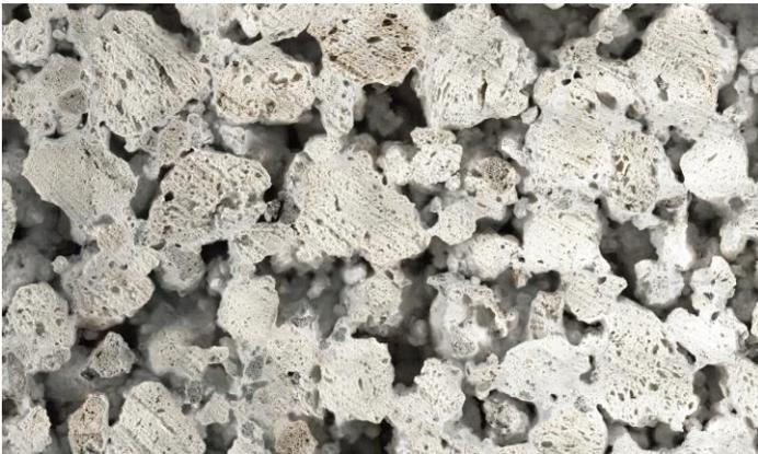
**Abbildung 2-1: Gefüge haufwerksporiger Leichtbeton**
