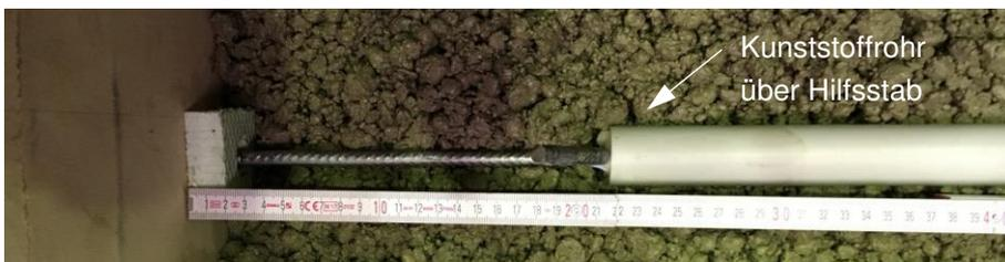
Abbildung 3-17: Bewehrungsstab mit Endhaken, angeschweißtem Hilfsstab und Kunststoffrohr
