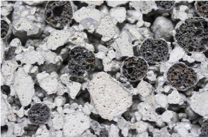
*Natürliche Zuschläge wie Bims oder Blähton sorgen für die Bildung von feinen Luftporen in den Leichtbeton-Steinen. Diese kleinen Hohlräume schließen die Wärme im Mauerwerk ein und sichern somit auch im Winter eine angenehme Raumtemperatur.*
