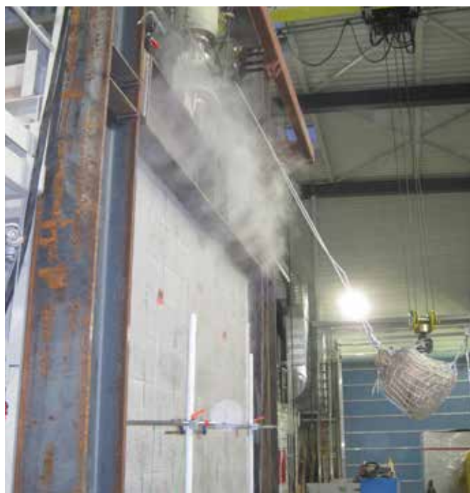
Bild 5.5: Stoßbeanspruchung der Brandwand nach 90 Minuten mittels eines 150 kg schweren Bleisacks. Über der Prüfwand ist der die Wand belastende Druckzylinder zu sehen.
