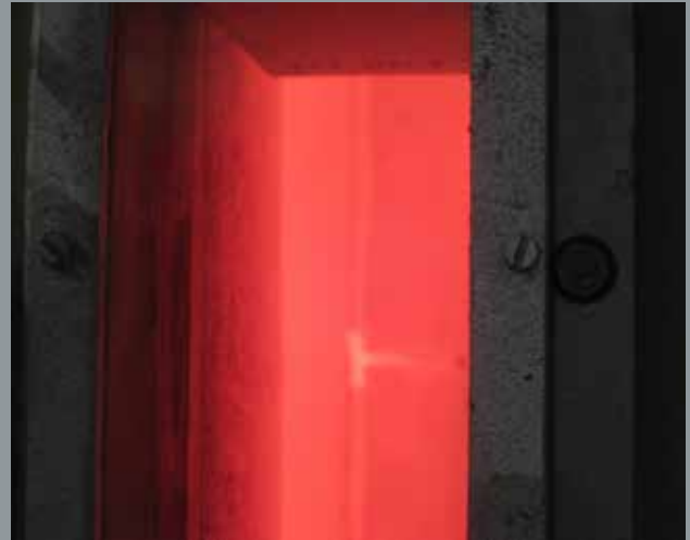
Bild 5.2: Rot glühende Wände im Inneren des Brandraums
