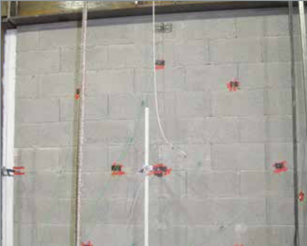
Bild 5.1: Vor einem Brandraum druckdicht eingebaute Prüfwand mit zur Messung ein-/ angebauten Thermoelementen
