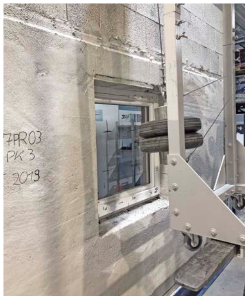
Bild 7 Zwillingsreifen für dynamischen Test gemäß DIN EN 1629 Twin tyre for dynamic test according DIN EN 1629
