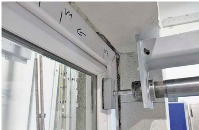
Bild 6 Auslenkung eines Fensterelementes bei der statischen Prüfung Deflection of a window within a static test
